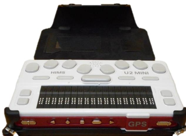
Органайзер Braille Sense - это мобильное электронное устройство с брайлевским и речевым выводом, предназначенное для слепых и слепоглухих пользователей.
